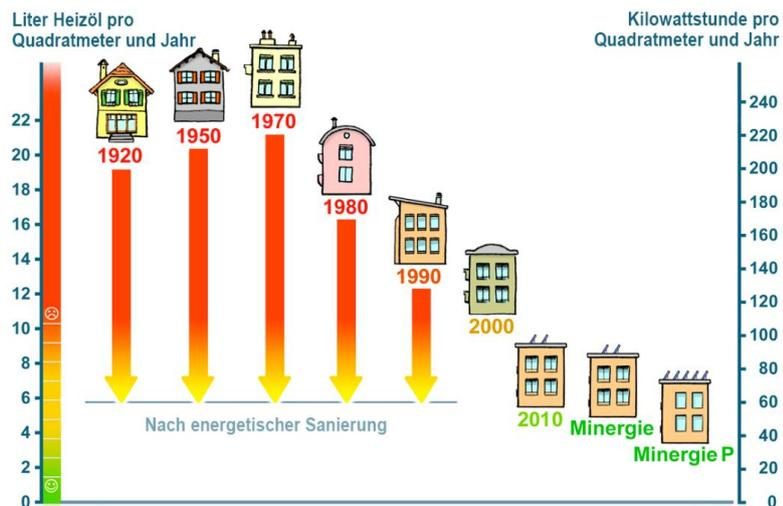
Abbildung 21: Energiekennzahl für den Bereich der Gebäudeheizung, nach Bauperiode. Quelle: <https://www.energie-umwelt.ch/haus/renovation-und-heizung/gebaeudeplanung/waermebedarf-und-geak>; Zugriff: 28.04.20.
